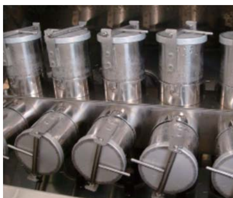
複合試験片が入った試験ピンをセット
